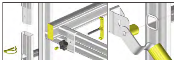
Système de fixation par goupille, noix d'assemblage et cliquetage automatique.
